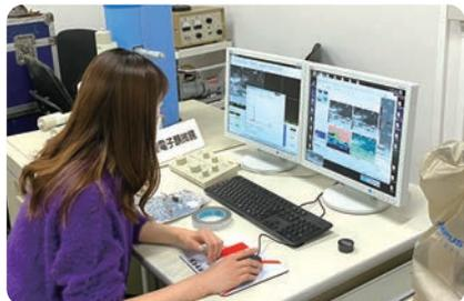
マイクロナ計測室(電子顕微鏡を使用した元素分析の様子)
